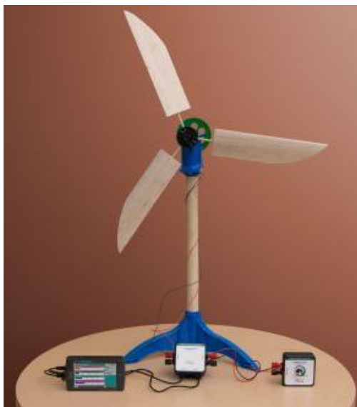
圖五 發電機組、可變負載與數位化量測系統
